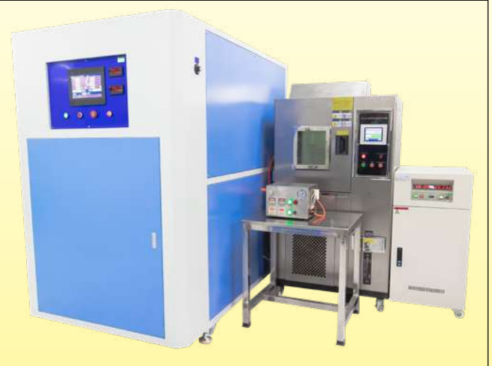
Equipement d'essai de durée de vie électrique des air switches. (Utilisé pour la vérification de la conformité aux normes UL et CE applicables)
